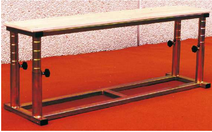
Art. 1PP40/2PP40/3PP40/1PP50/2PP50/3PP50 Panca per pliometria in acciaio verniciato, lunghezze disponibili: cm. 100 / cm. 200 / cm. 300 larghezza cm. 35 altezze disponibili: cm. 40 / cm. 50 piano di appoggio in legno rivestito in gomma antiscivolo Plyometric bench in painted steel, available length 100 / 200 / 300 cm. width 35 cm. available height 40 / 50 cm. board made of wood with anti-skid rubber cover
